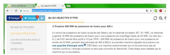
TEXT: "Produire 500 MW de puissance de fusion pour 400 s - Le record de puissance de fusion produite est détenu par le tokamak européen JET. En 1997, ce tokamak a généré 16 MW de puissance de fusion pour une puissance de chauffage totale de 24 MW. Ce ratio (ou « Q ») de 0,67 devrait être porté à 10 par ITER—500 MW de puissance de fusion pour une puissance en entrée de 50 MW, pendant des périodes de 400 à 600 s, la première machine capable de produire une une quantité d'énergie nette. I
