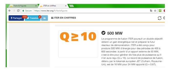
TEXT: "Le programme de fusion ITER poursuit un double objectif: obtenir un gain énergétique net et préparer le futur réacteur de démonstration. ITER a été conçu pour produire 500 MW d'énergie pour des périodes de 400 à 600 secondes à partir d'un apport externe de 50 MW, c'est-à-dire pour générer dix fois plus de puissance qu'il n'en aura reçu ( $Q \ge 10$ ). Le record de puissance de fusion, détenu par le tokamak européen JET (Culham, Royaume-Uni), est de 16 MW pour 24 MW apporté (Q = 0.67)."
