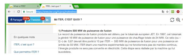
TEXT: "Produire 500 MW de puissance de fusion - Le record de puissance de fusion produite est détenu par le tokamak européen JET. En 1997, cet tokamak a généré 16 MW de puissance de fusion pour une puissance de chauffage totale de 24 MW. Ce ratio (ou « Q ») de 0,67 devrait être porté à 10 par ITER — 500 MW de puissance de fusion pour une puissance en entrée de 50 MW."
