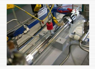
"Dispsoitivo a membrana di permeazione per la purificazione di idrogeno" Italian Patent n. RM2009U000143, 2009
