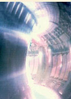
Una imagen dividida del experimento JET, con el plasma de alta temperatura a la derecha.
