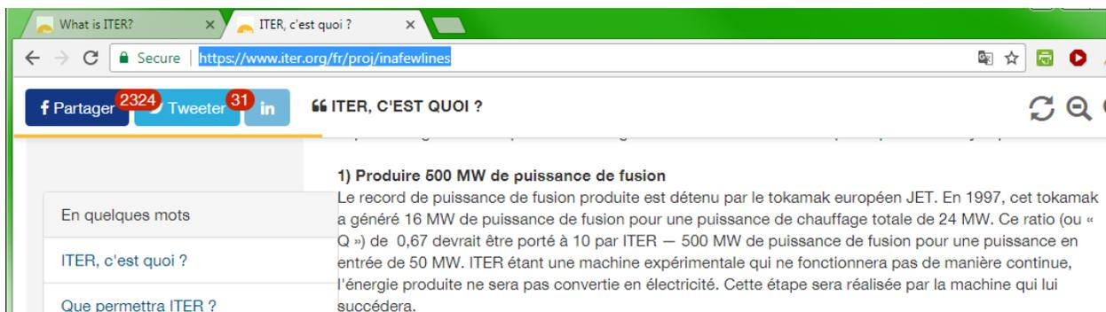
TEXT: "Produire 500 MW de puissance de fusion - Le record de puissance de fusion produite est détenu par le tokamak européen JET. En 1997, cet tokamak a généré 16 MW de puissance de fusion pour une puissance de chauffage totale de 24 MW. Ce ratio (ou « Q ») de 0,67 devrait être porté à 10 par ITER — 500 MW de puissance de fusion pour une puissance en entrée de 50 MW."
