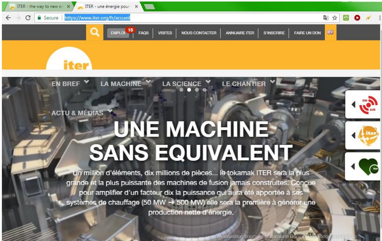
TEXT: "Un million d'éléments, dix millions de pièces... le tokamak ITER sera la plus grande et la plus puissante des machines de fusion jamais construites. Conçue pour amplifier d'un facteur dix la puissance qui aura été apportée à ses systèmes de chauffage (50 MW → 500 MW) elle sera la première à générer une production nette d'énergie."
